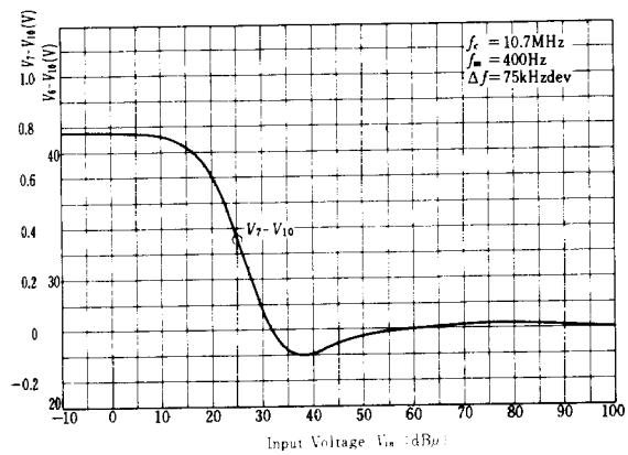
**$V_7 - V_{10}$ ,  $V_{12}$  DETUNING FREQUENCY CHARACTERISTICS**
